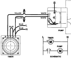
WIRING DIAGRAM FOR TIMER CONTROL ONLY
